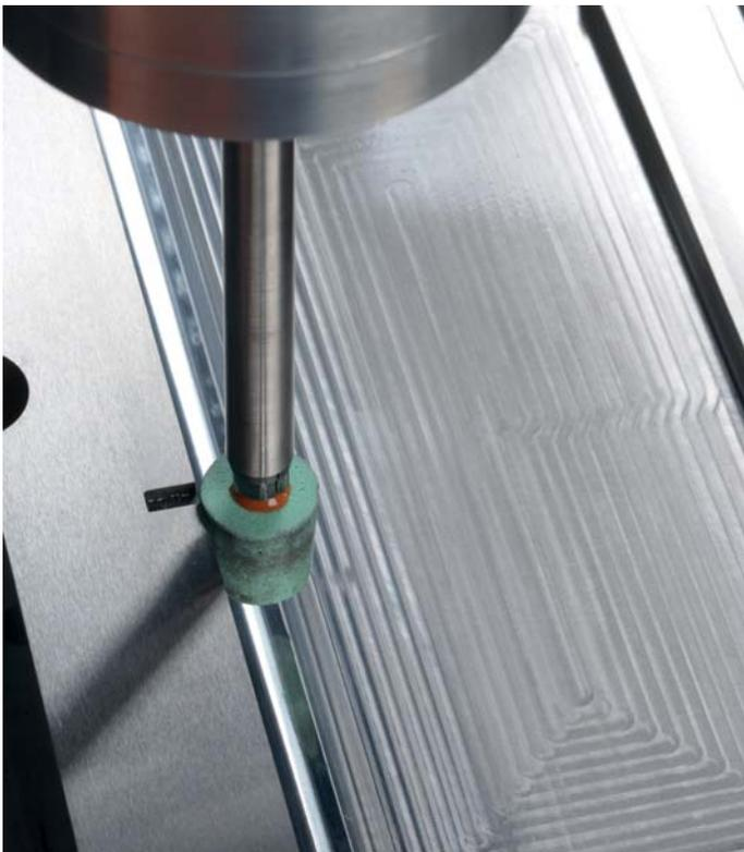
Der chemische Aufbau der Bindung bestimmt die späteren Eigenschaften des Werkzeugs. Faktoren wie Härte, Elastizität, Kornart, Korngröße und Kornanteil lassen sich unterschiedlich kombinieren und variieren. Auf diese Weise lässt sich das Werkzeug optimal an die jeweilige Schleif- oder Polieraufgabe anpassen.
