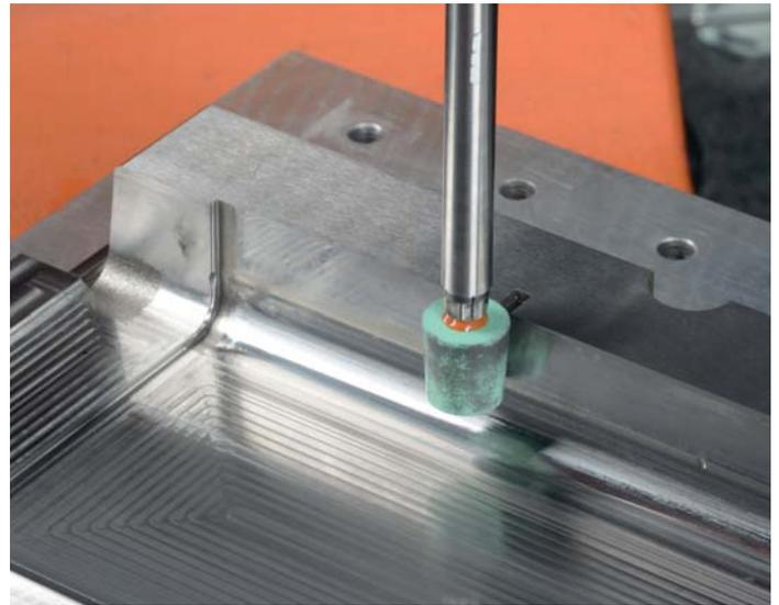
Außerdem wurde im Projekt ein rotatorisches Werkzeugsystem für Drehzahlen bis zu 12 000 1/min, einer radialen Anpresskraft von 75 N und einer Eintauchtiefe von 90 mm entwickelt.
