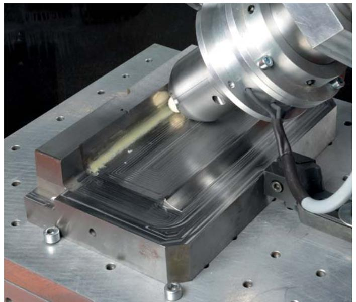
Im weiteren Projektverlauf wurden die Hon- und Polierwerkzeuge auf den neu entwickelten Werkzeugsystemen in umfangreichen Parameterstudien qualifiziert. Ausgehend von der gefrästen Bauteiloberfläche konnten die unterschiedlichen Geometrielemente des Demonstrators in mehreren Bearbeitungsschritten bis auf Hochglanz gehont und poliert werden.
