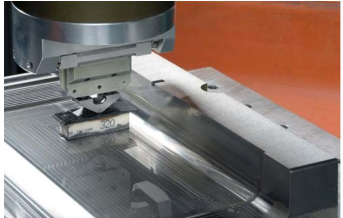
Grundlage dieser hohen Abtragraten sind die selbstschärfenden Eigenschaften des neuen Bindungssystems: Sobald ein Schleifkorn stumpf wird, gibt die Bindung dieses frei und ein neues, schneidfähiges Korn kommt an der Werkzeugoberfläche zum Einsatz.
