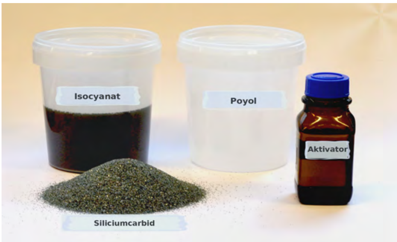
Rohstoffe der Polyurethanbindung (Werkfoto ARTIFEX)
