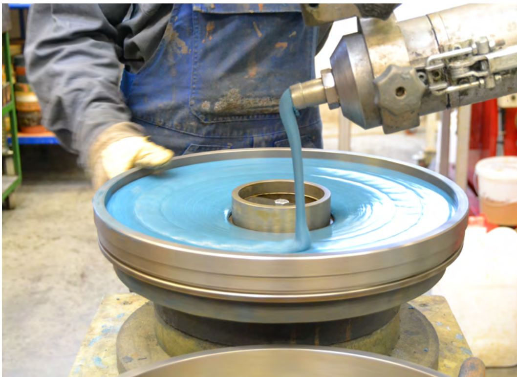
Abfüllen der Masse in Formen (Werkfoto ARTIFEX)
