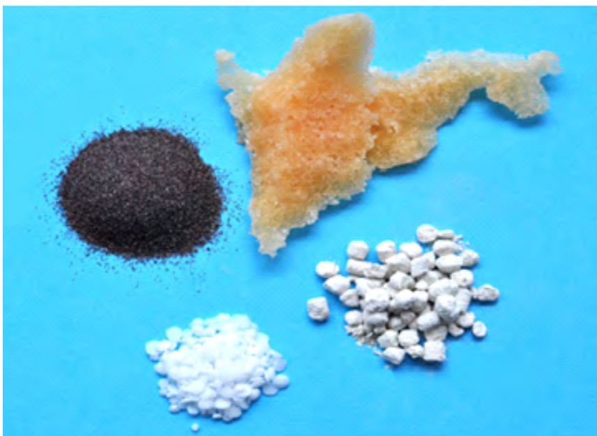
Bild 1: Bindungsaufbau (v. l. n. r.) aus Schleifkorn, Kautschuk und Additiven (Werkfoto Artifex)
