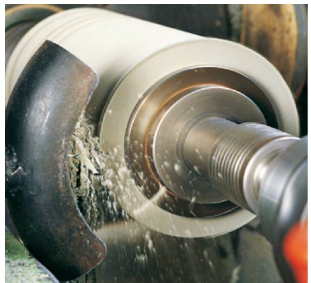
Bild 4: Abdrehen von elastischen Schleifscheiben (Werkfoto Artifex)
