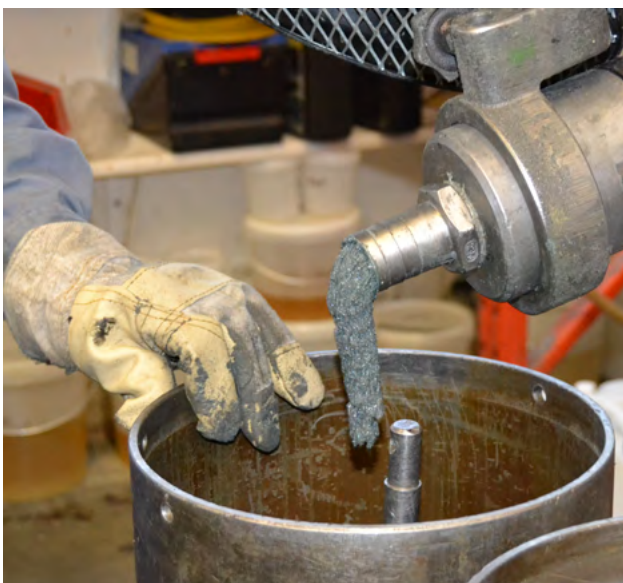
Bild 3: Arbeitsschritt Abfüllung in Formen bei einem Polyurethansystem (Werkfoto Artifex)
