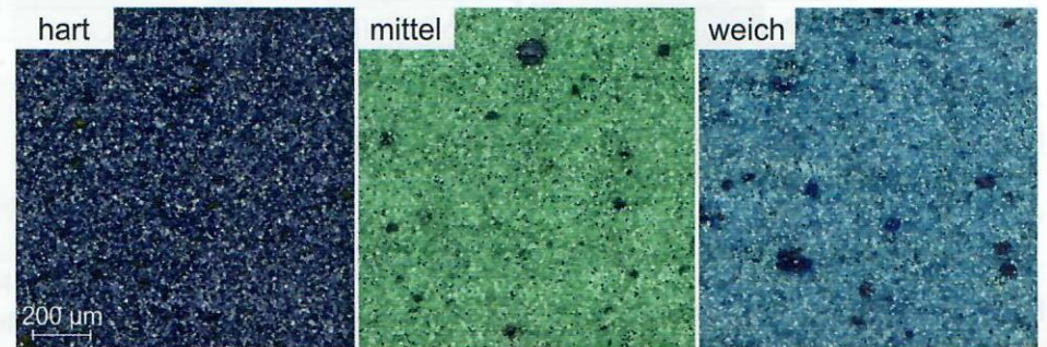
Abb. 2: Spezifikation der eingesetzten nachgiebigen Diamantschleifscheiben
